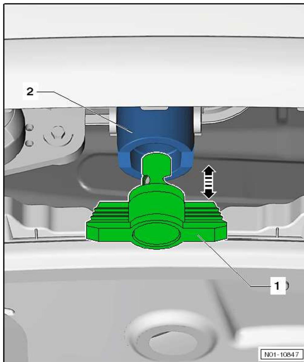
Après avoir mis en place la rotule, le repère vert sur la molette doit être orienté vers le repère blanc de la rotule. La molette doit complètement être en appui. Ensuite, la serrure du dispositif de suspension doit pouvoir être fermée en retirant la clé. Si tel n'est pas le cas, effectuer les opérations de réparation suivantes.
